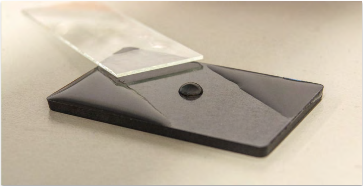
Bild 23: Polyolefinoberfläche durch Maskierung nach wie vor nicht benetzbar in der Mitte, der Flüssigkeitstropfen bleibt „sitzen“; Ecken links und rechts aktiviert und die Flüssigkeit benetzt flächig
