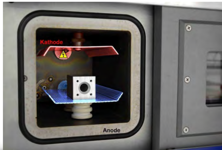
Bild 6: Lagerung des Substrats auf „floating Potential“
