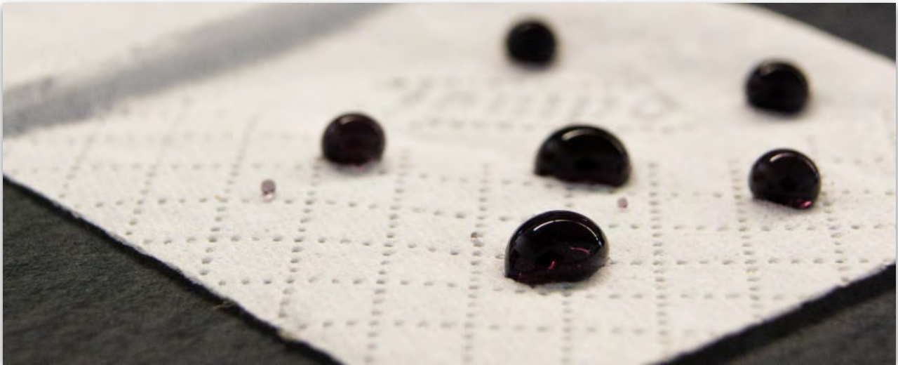
Bild 34: hydrophobierte, nicht saugende Oberfläche
