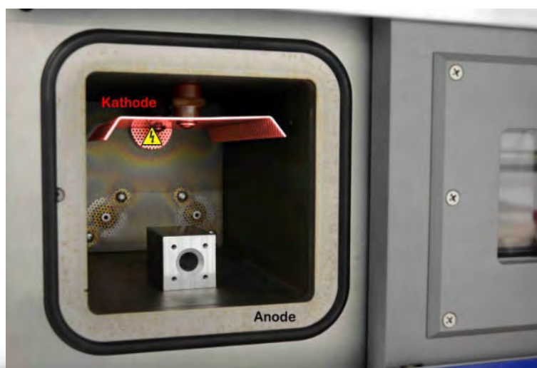
Bild 5: Lagerung des Substrats auf der Anode
