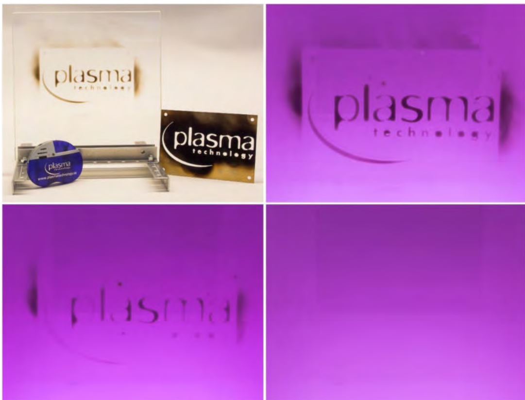
Bild 15: links oben: maskierte Glasplatte nach der Berußung; Blick in die Plasmakammer während der Glasplattenreinigung im Niederdruckplasma; rechts oben: Start, links unten: nach 60 Sekunden, rechts unten - gereinigte Glasoberfläche nach 120 Sekunden (Zeitangaben gelten für diese Reinigung)
