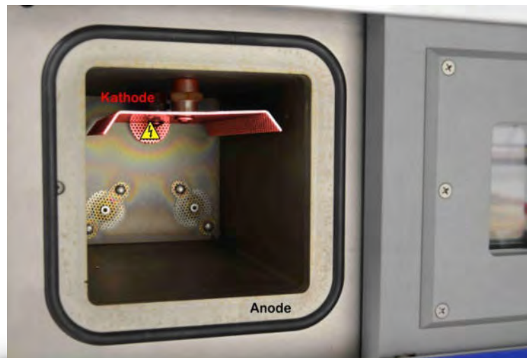
Bild 3: Kapazitiv gekoppelte NF-/HF-Plasmaanlage, bei der die Kammerwand als Anode geschaltet ist
