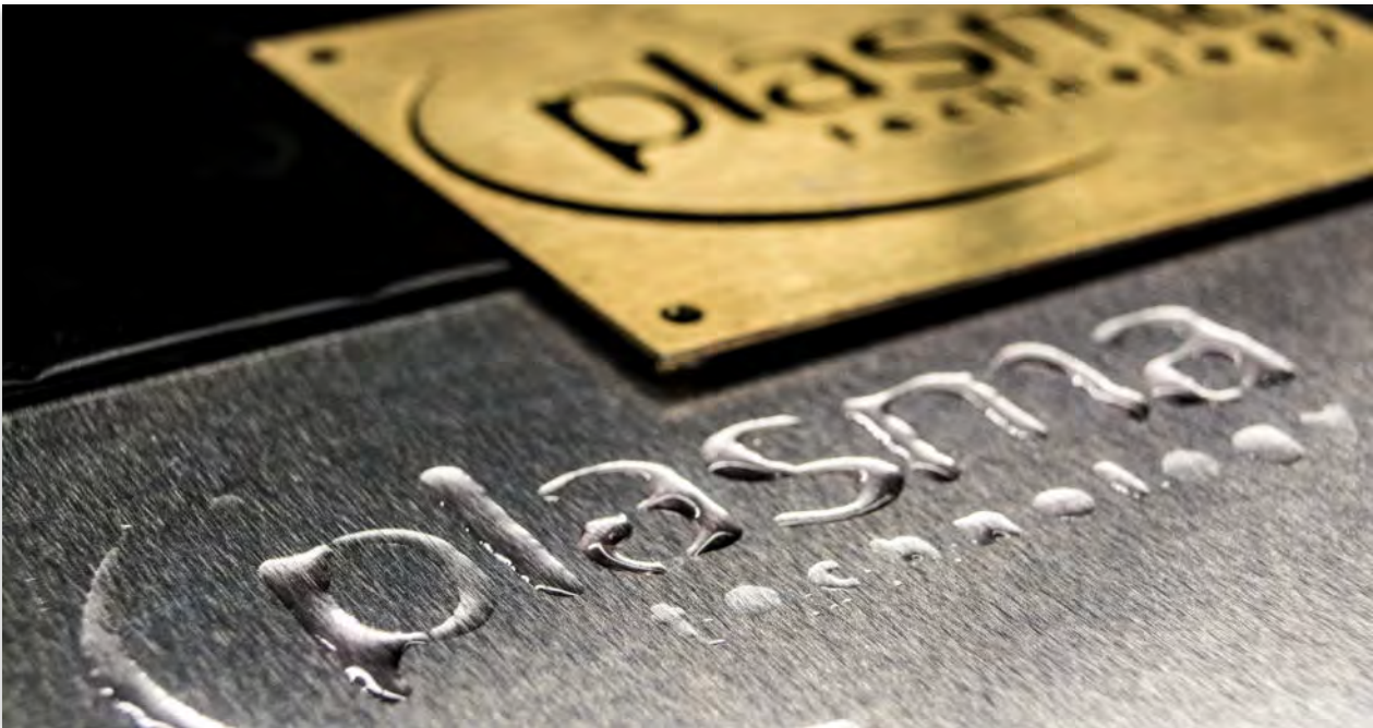
Bild 27: Mit einer Maske durchgeführter Plasmaprozess; am Schriftzug ist sehr gut zu erkennen, dass filigrane, scharf konturierte Strukturen erzeugt werden können
