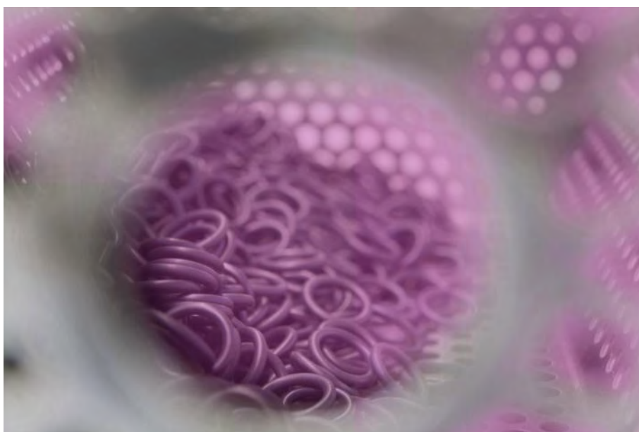
Bild 19: Dichtringe während des Reinigungsprozesses in einer drehenden Plasmakammer
